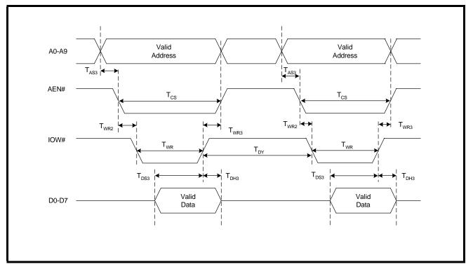
FIGURE 26. RECEIVE READY & INTERRUPT TIMING [NON-FIFO MODE]
