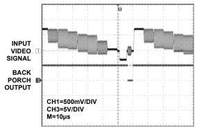
FIGURE 37. NTSC VIDEO SIGNAL WITH BACK PORCH OUTPUT
