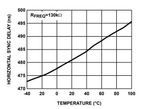
FIGURE 28. HORIZONTAL DELAY vs TEMPERATURE
