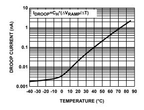
FIGURE 19. DROOP CURRENT vs TEMPERATURE
