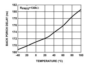
FIGURE 30. BACK PORCH DELAY vs TEMPERATURE -FSEL = 0
