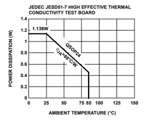
FIGURE 35. PACKAGE POWER DISSIPATION vs AMBIENT TEMPERATURE
