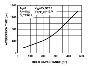
FIGURE 16. ACQUISITION TIME vs HOLD CAPACITANCE
