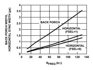
FIGURE 24. BACK PORCH AND HORIZONTAL SYNC WIDTH vs  $\mathsf{R}_{FREQ}$
