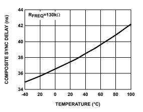
FIGURE 26. COMPOSITE DELAY vs TEMPERATURE -FSEL = 0
