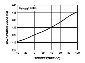
FIGURE 31. BACK PORCH DELAY vs TEMPERATURE -FSEL = 1
