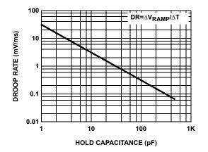
FIGURE 21. DROOP RATE vs HOLD CAPACITANCE
