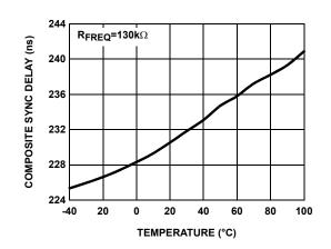
FIGURE 27. COMPOSITE DELAY vs TEMPERATURE -FSEL = 1
