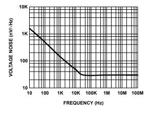
FIGURE 11. VOLTAGE NOISE vs FREQUENCY - VIDEO AMP
