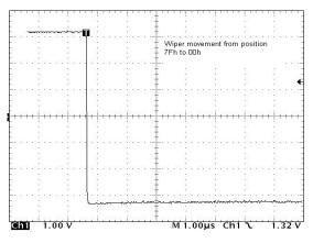
FIGURE 14. LARGE SIGNAL SETTLING TIME
