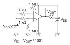
7. Input Offset Voltage, V<sub>IO</sub>
