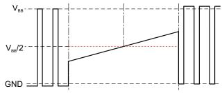
Figure 18e: Non-Synchronous Fast Decay
