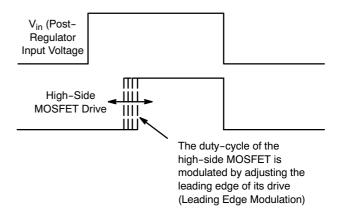
Figure 21. Leading Edge Modulation
