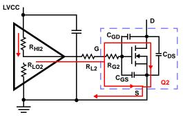
FIGURE 7. TYPICAL LOWER-GATE DRIVE TURN-ON PATH
