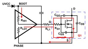
FIGURE 6. TYPICAL UPPER-GATE DRIVE TURN-ON PATH
